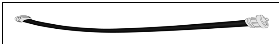
Verbindungsschlauch zur Wasserversorgung der Sprühdüsen
