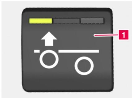
**1** Taste Entlasten Vorlaufachse
