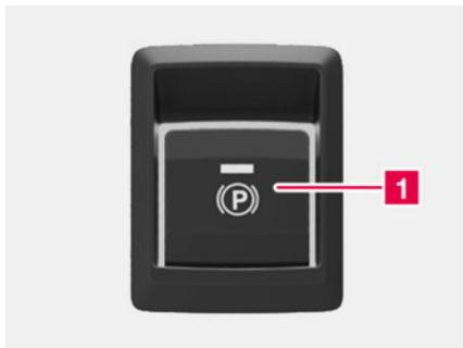
**1** Bedienelement Elektrische Feststellbremse
