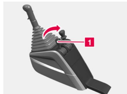
**1** Hebel Streckbremse
