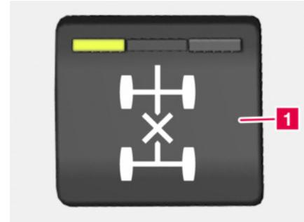
**1** Taste Längsausgleichssperre Hinterachse
