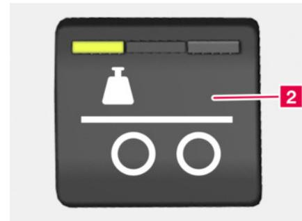
**2** Taste Anfahrhilfe 2. angetriebene Hinterachse
