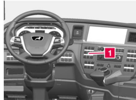
**1** Taste Spurwechselhilfe
