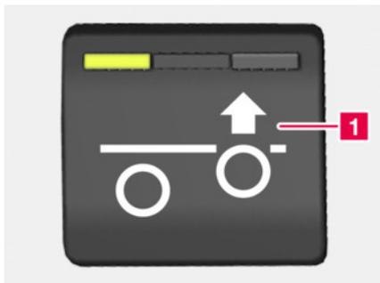
**1** Taste Entlasten Nachlaufachse
