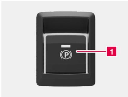
**1** Bedienelement Elektrische Feststellbremse
